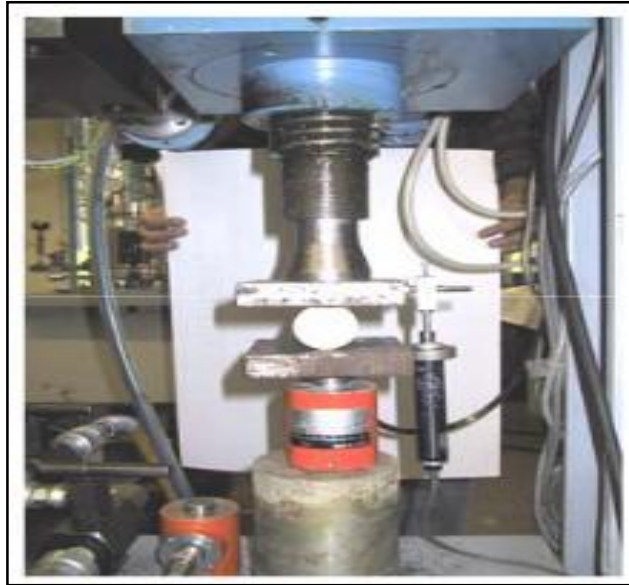
Figure (II.8) : Essai Brésilien sur Presse Mécanique (ULG)
