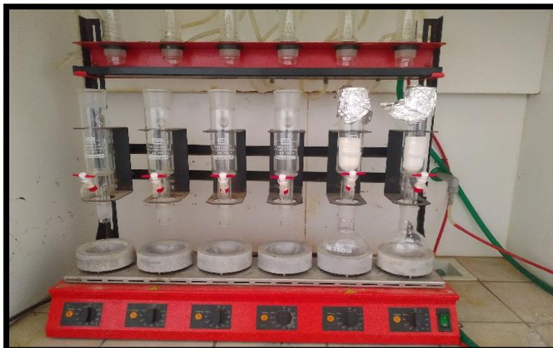
**Figure 11** : Extraction des HAPs par l'appareil Soxhlet.
