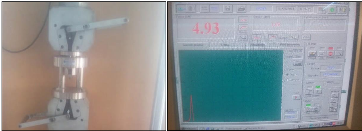
Figure II.15 (a) Presse de flexion 3 points et (b) le système d'acquisition des données.
