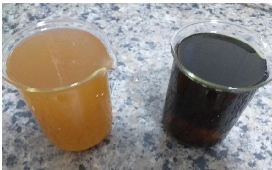
Figure II.7 Photographie des superplastifiants : (à gauche) SIKA VISCOCRETE TEMPO 12 et (à droite) SIKA VISCOCRETE 3045.
