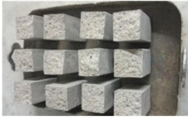
Figure II.20 Principe de l'essai d'absorption d'eau par capillarité.
