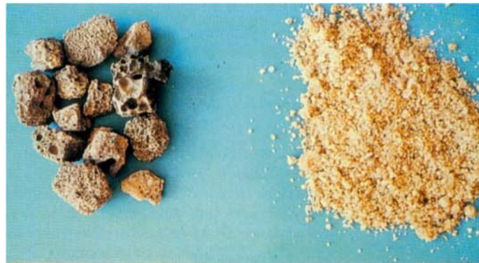
Figure I.5 Photographie de laitiers de haut fourneau non broyés : laitier cristallisé (à gauche) et laitier vitrifié (à droite).
