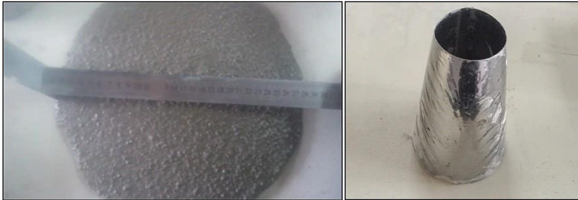
Figure III.9 Essai au mini-cône : (à gauche) galette du MHP et (à droite) mini-cône.
