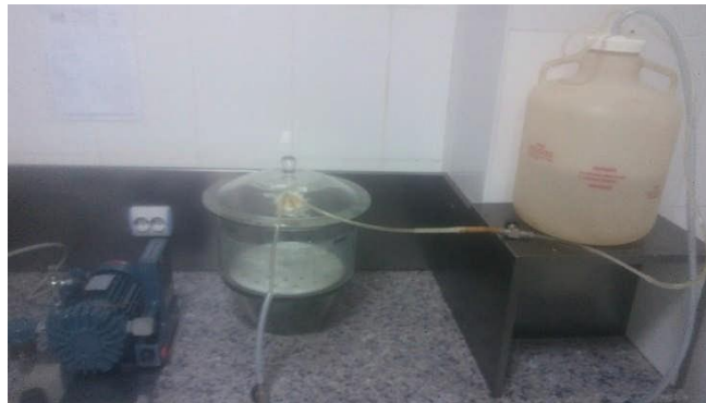
Figure II.18 Dispositif expérimental pour la porosité ouverte à l'eau.
