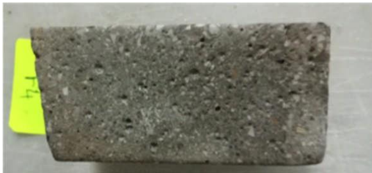
Figure V.5 Etat visuel d'une éprouvette (F4) conservée dans la solution d'acide nitrique.
