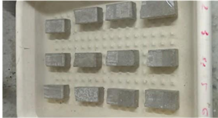
Figure II.19 Principe de l'essai d'absorption d'eau par immersion.
