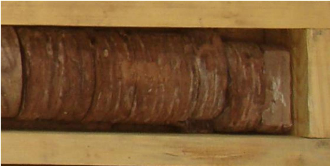
**Figure. II.16:** Carotte montrant une argile rouge de structure feuilletée
