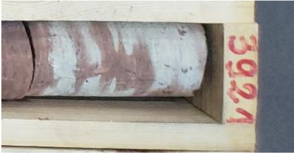
**Figure. II.6:** Carotte montrant des grés gris prélevé à la profondeur 3921
