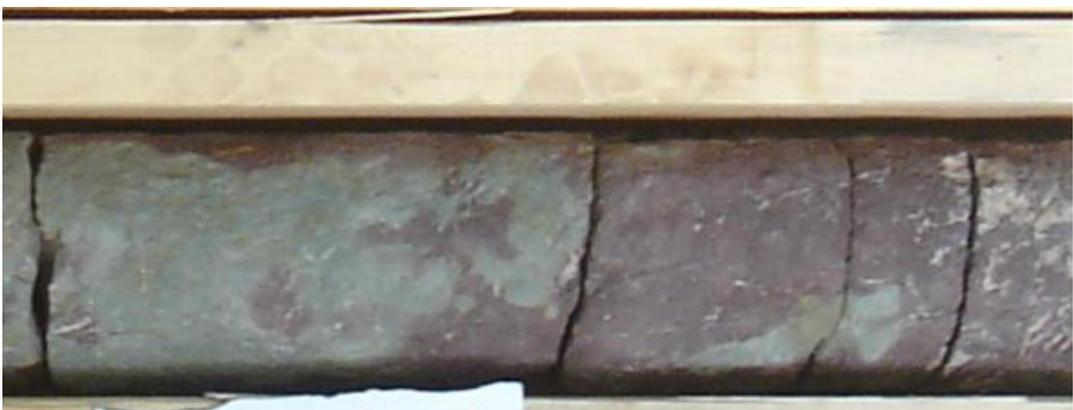
**Figure. II.10:** Carotte montrant un argile vert prélevé à l'intervalle 3750 – 3752
