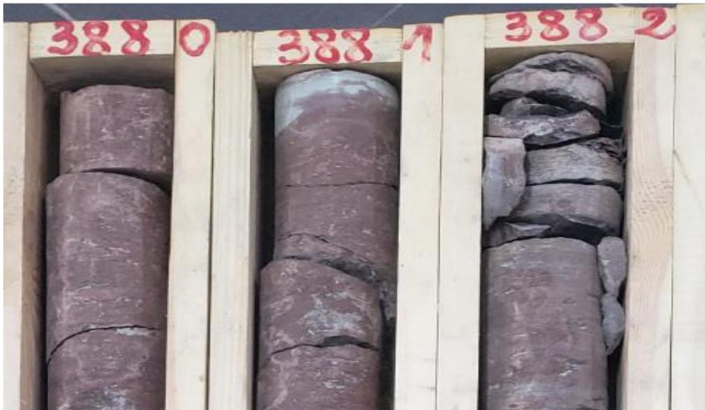
**Figure. II.3:** Carotte montrant des argiles brun rouge à l'intervalle 3880-3882
