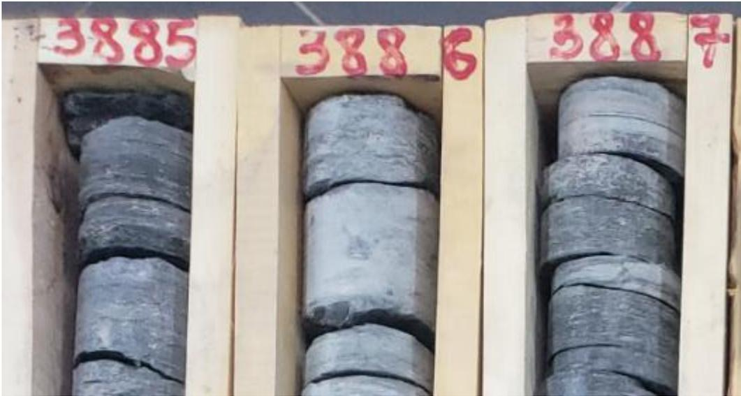
**Figure. II.4:** Carotte montrant un complexe grés-argileux à l'intervalle 3885-3887
