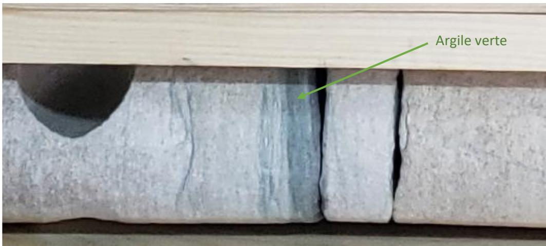
**Figure. II.5:** Carotte montrant des argiles vertes
