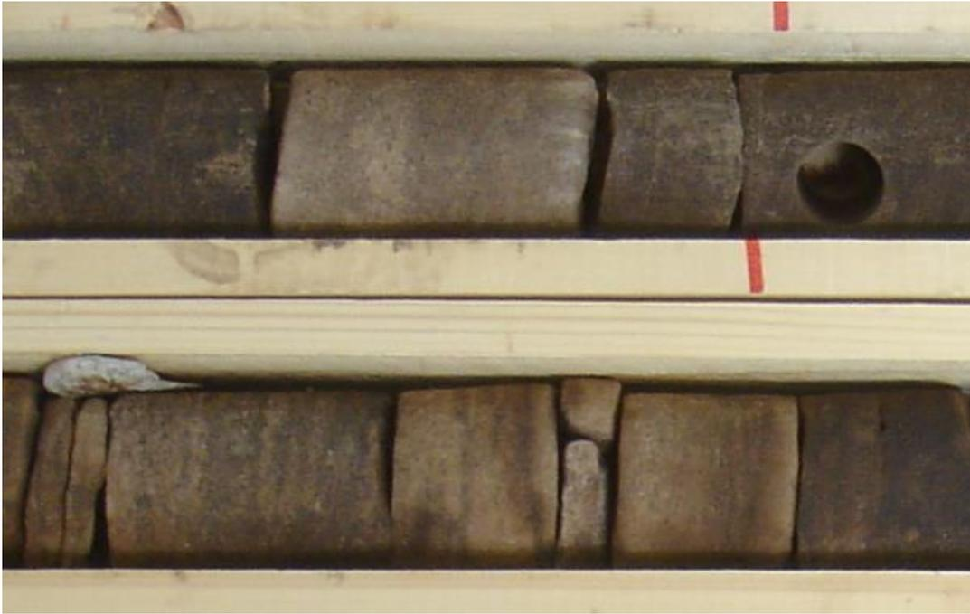
**Figure. II.9:** Carotte montrant des grés prélevés à l'intervalle 3747– 3748
