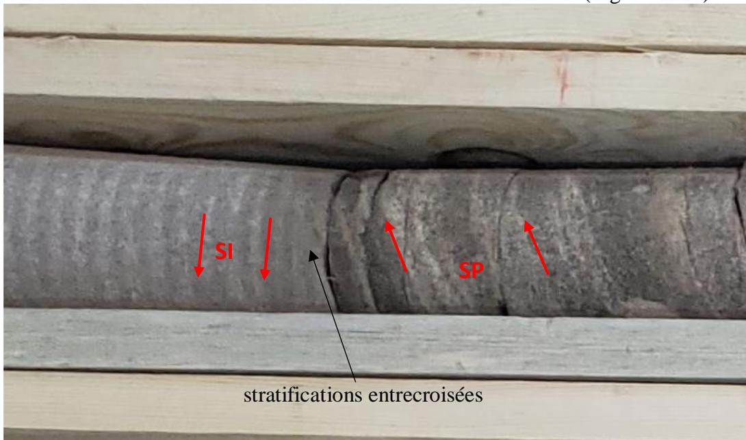
**Figure. II.25:** Echantillon de carotte montrant les grés à stratifications entrecroisées
