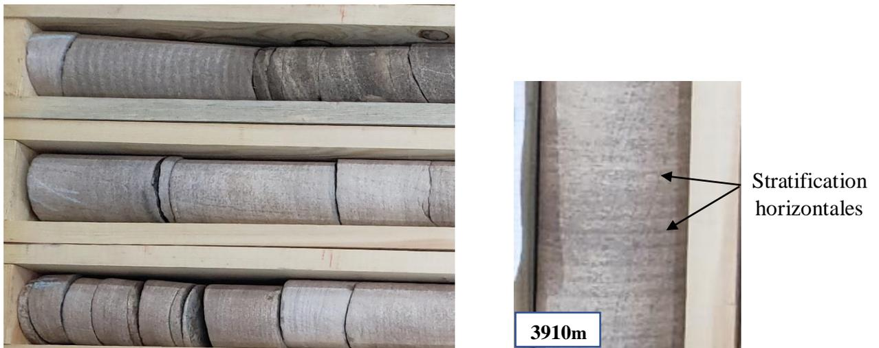
**Figure. II.24:** Echantillon de carotte montrant les grés à stratifications planes dans le puits HJR-3
