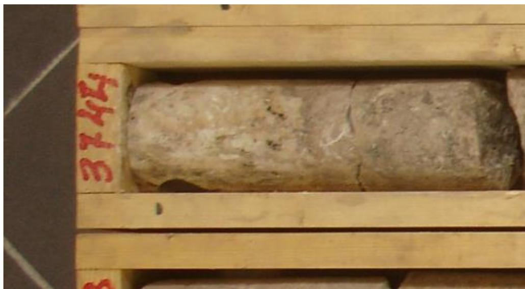
**Figure. II.19:** Carotte montrant une anhydrite prélevée à l'intervalle 3734 – 3752
