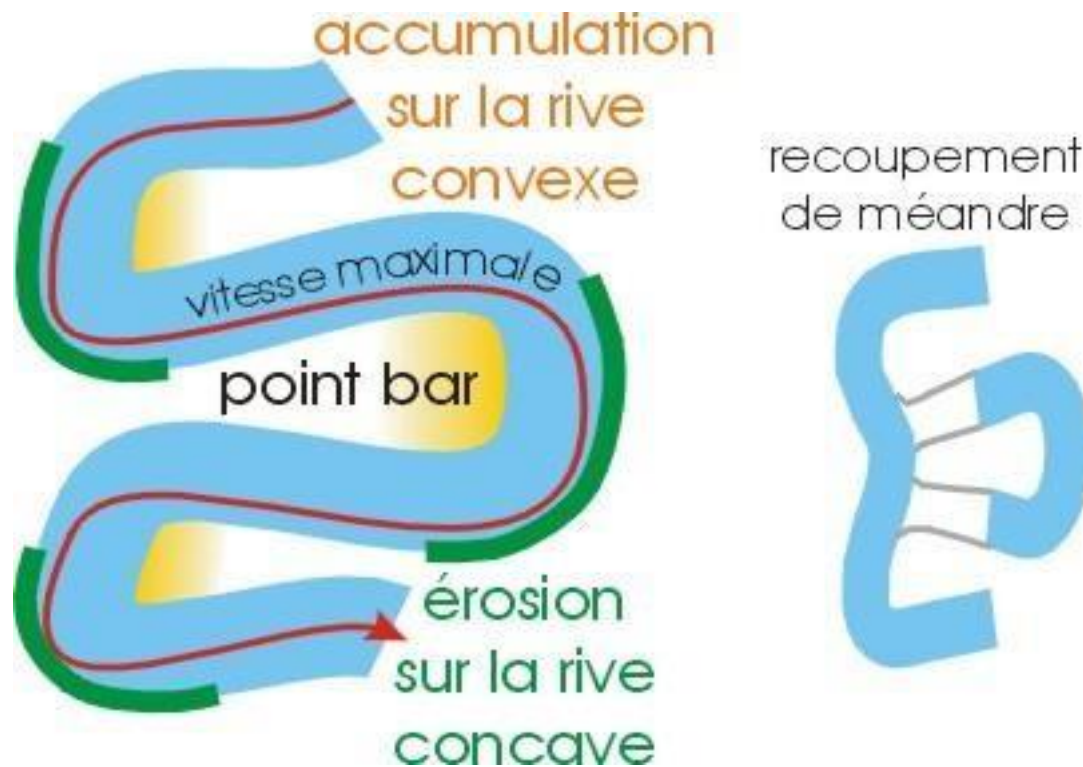
Figure 15 : formation des méandres par érosion de la rive concave et sédimentation sur la rive convexe. L'ensemble se déplace vers l'aval. Recoupement de méandre et développement d'un méandre abandonné (Boulvain, 2014)
