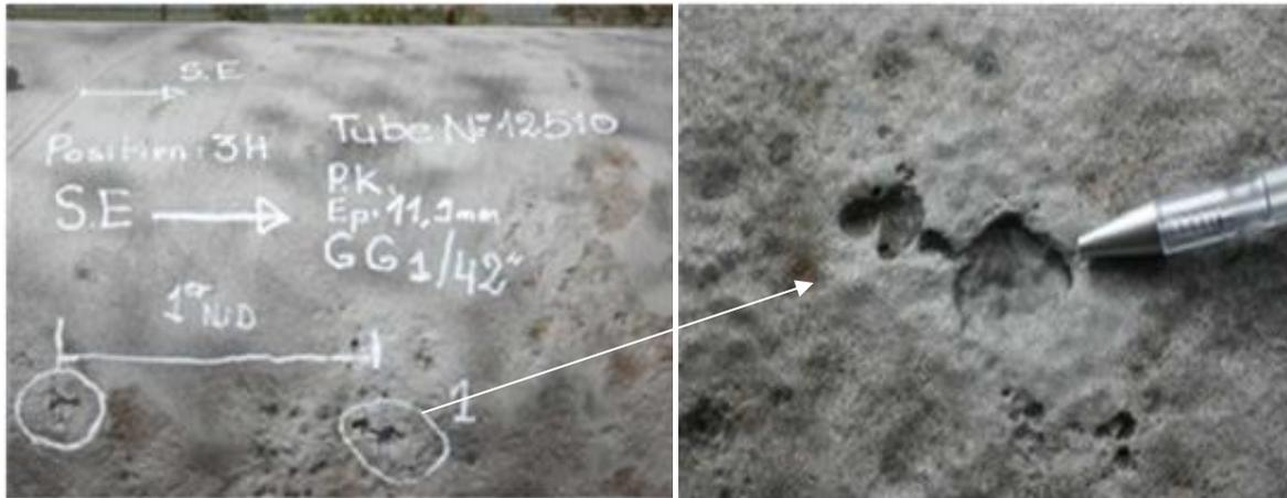
Figure I.10 : Présentation du défaut N°1 avant l'essai d'éclatement.
