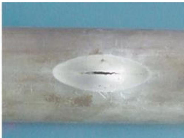
Figure III.3 : Éprouvette après éclatement [17].
