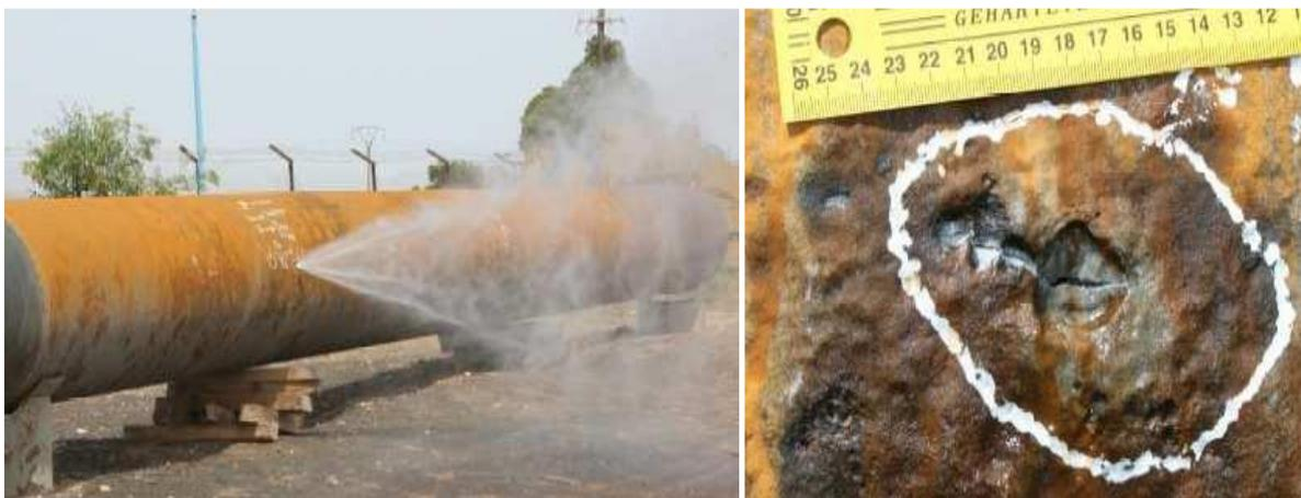
Figure I.11 : Résistance de l'ensemble du nid de corrosion (a) et état du gommage (b) à 90 bars de pression.
