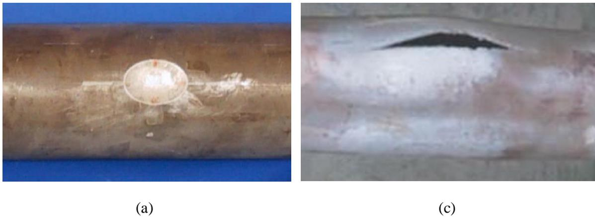
Figure IV.5 : (a) Éprouvette avec un défaut induit. (b) Spécimens d'essai après l'éclatement.
