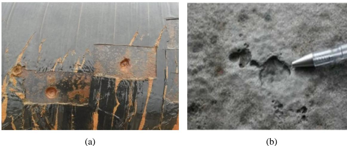
Figure II.3 : (a) Exemples de défaillances de pipelines dues à des corrosions externes (TRC, 2016), (b) Esquisse sur la longueur, la largeur et la profondeur irrégulières d'un défaut de corrosion typique (TRC, 2011).
