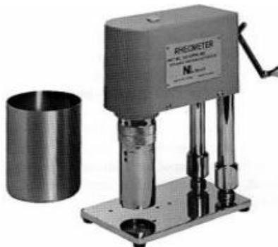
Figure 21 : Viscosimètre Fann.
