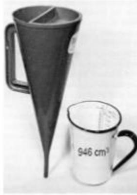
Figure 20: Viscosimètre Marsh.
