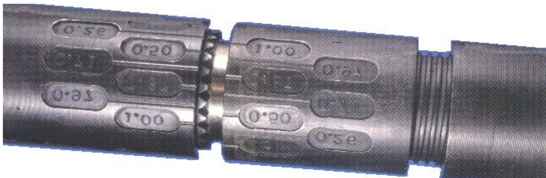
Figure 16 :Coude ajustable incorporé au moteur (en position débloquée)
