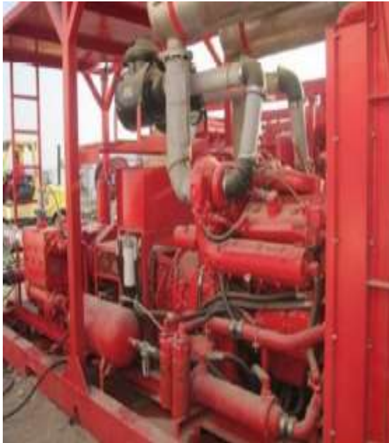
FIGURE 34 : LA POMPE DE PRESSION DE RETOUR [36].
