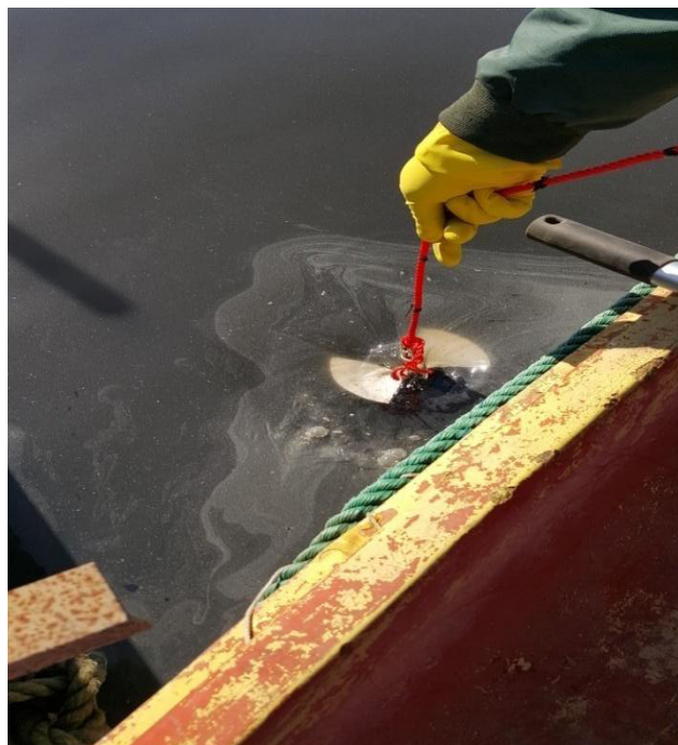
Figure 11: Disque de Secchi conçu lors de l'étude
