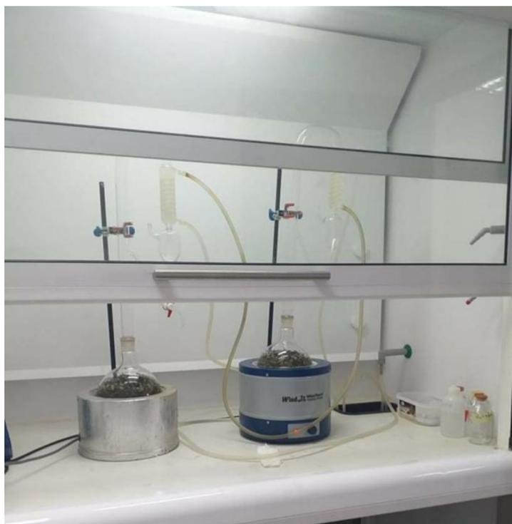
**Fig. n°08 :** Dispositif d'hydrodistillation (Appareil Clivenger) (Photo originale).
