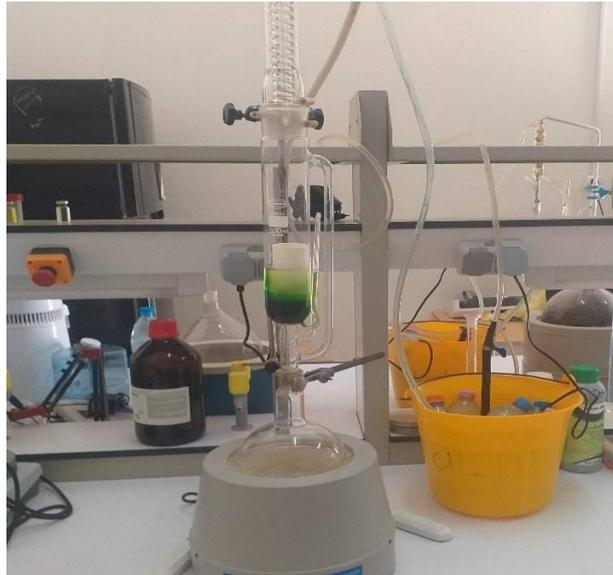
**Fig. n°09 :** Dispositif de préparation de l'extrait alcoolique par extraction au Soxhlet (photo originale).
