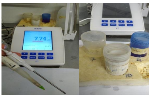
pH-mètre avec les solutions étalons (pH=4, pH=7, pH=10)
