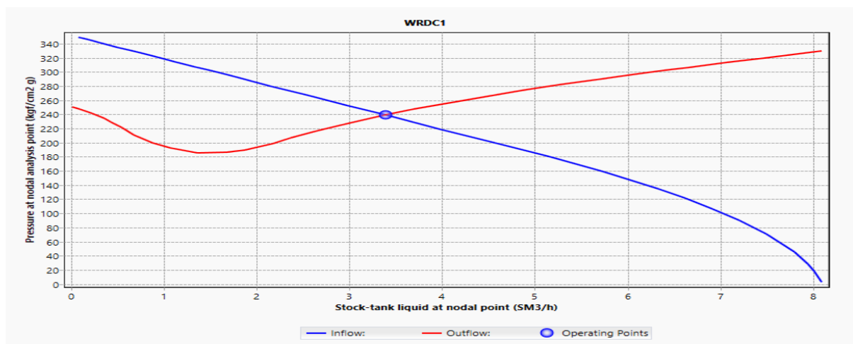
Figure 2 : Point opérationnel du puits WRDC1 après actualisation
