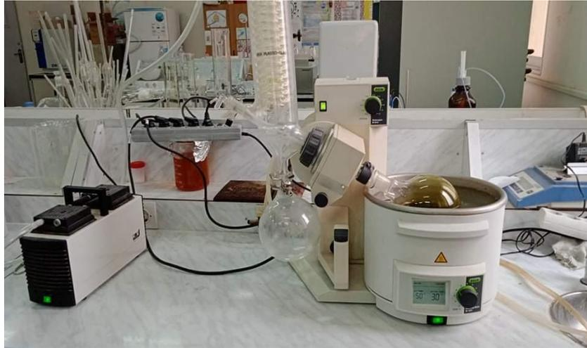
**Figure 18 :** Evaporateur rotatif de type BUCHI R-210. (Laboratoire de génie de procéder, FT–BOUMERDES ; 2021)
