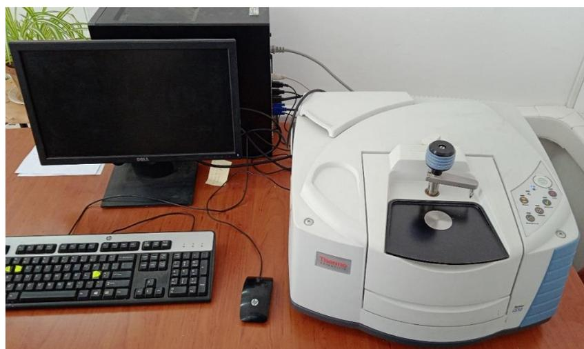
**Figure 19 .** Appareil infrarouge Thermo Scientific Nicolet IS 10 (Laboratoire de traitement et mise en forme des polymères, INH –BOUMERDES ;2021)
