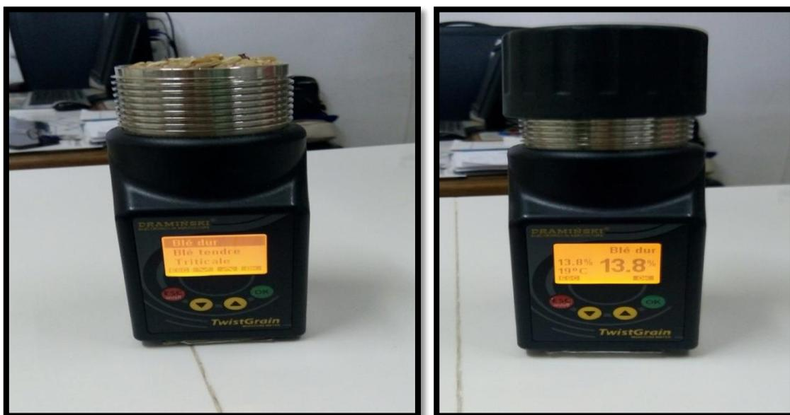
Figure 20 : La mesure de la température et l'humidité des grains par l'humidimètre.
