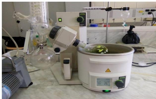
Figure 29: Montage de Rotavapor employé pour l'extraction brut éthanolique
