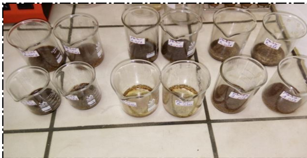
Figure 13. La minéralisation de la (MVS)
