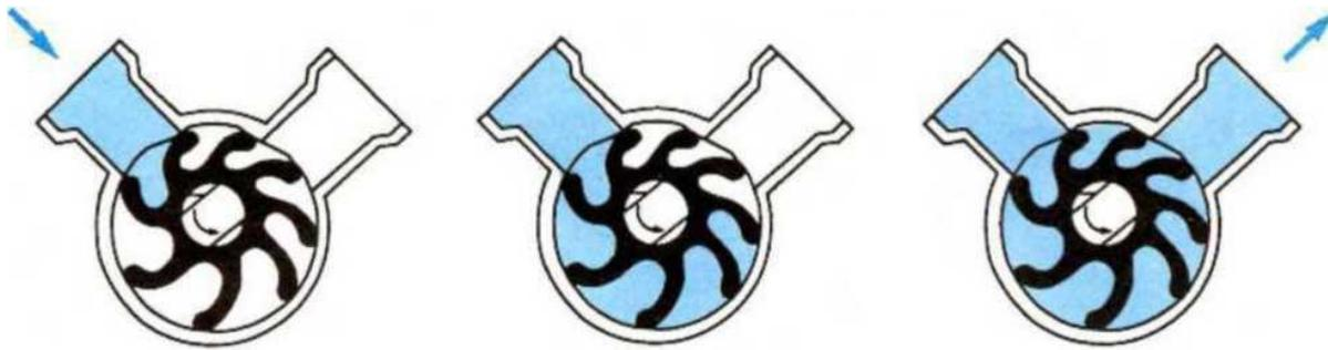
**Figure III.8 :** Pompe à palettes flexibles
