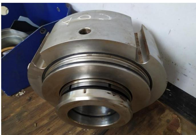
Figure IV.13 : Garnitures mécaniques
