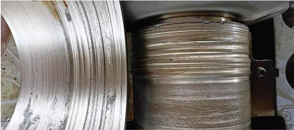
**Figure IV.28 :** Usure abrasive du piston et douille d'équilibrage
