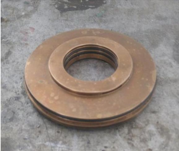
Figure IV.11 : Bague d'étanchéité de la butée
