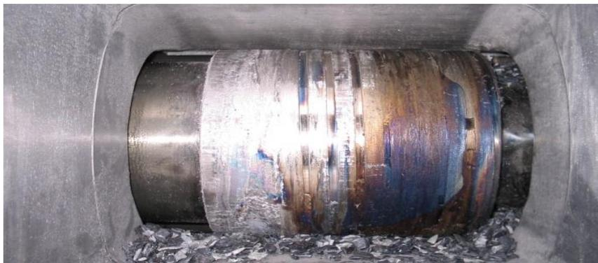
Figure II.6 : Grippage des talons de vis d'extrudeuse [14]
