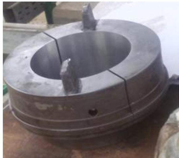
**Figure IV.8 :** Douille d'équilibrage
