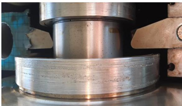
**Figure IV. 23** : Grippage de la bague d'usure du troisième étage
