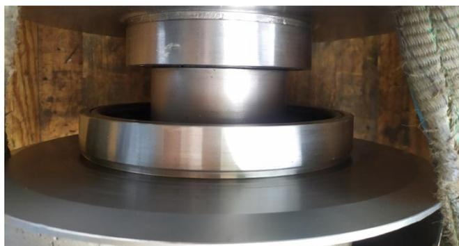
**Figure IV. 24** : La bague d'usure du troisième étage
