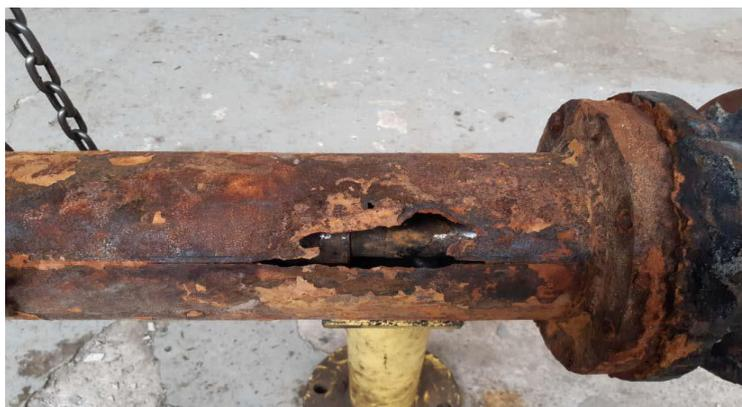
Figure II.7 : Corrosion d'une pompe V65 bassin anti- incendie
