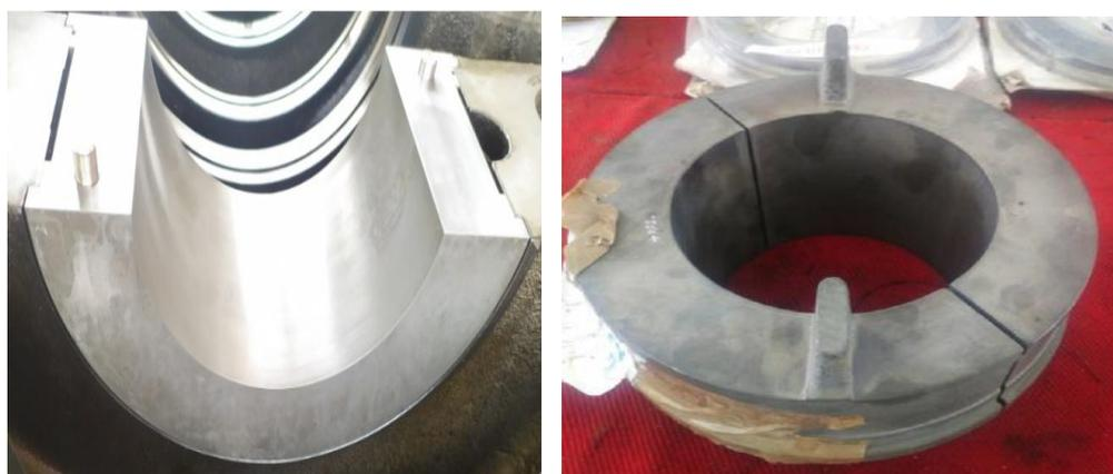
**Figure IV. 20 :** La douille d'équilibrage
