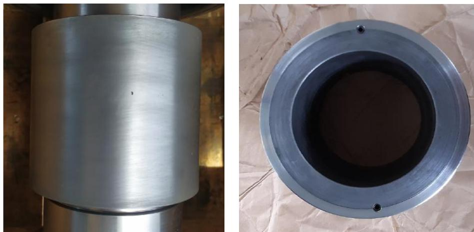
**Figure IV.19 :** Le piston d'équilibrage confectionné par DML
