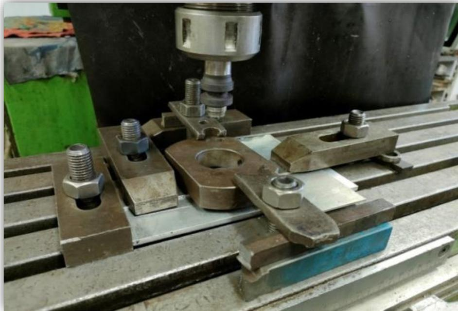
Figure 27 : Système de bridage.
