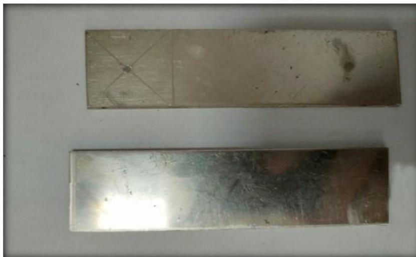
Figure 22 : Plaques d'aluminium du type 7075-T6.
