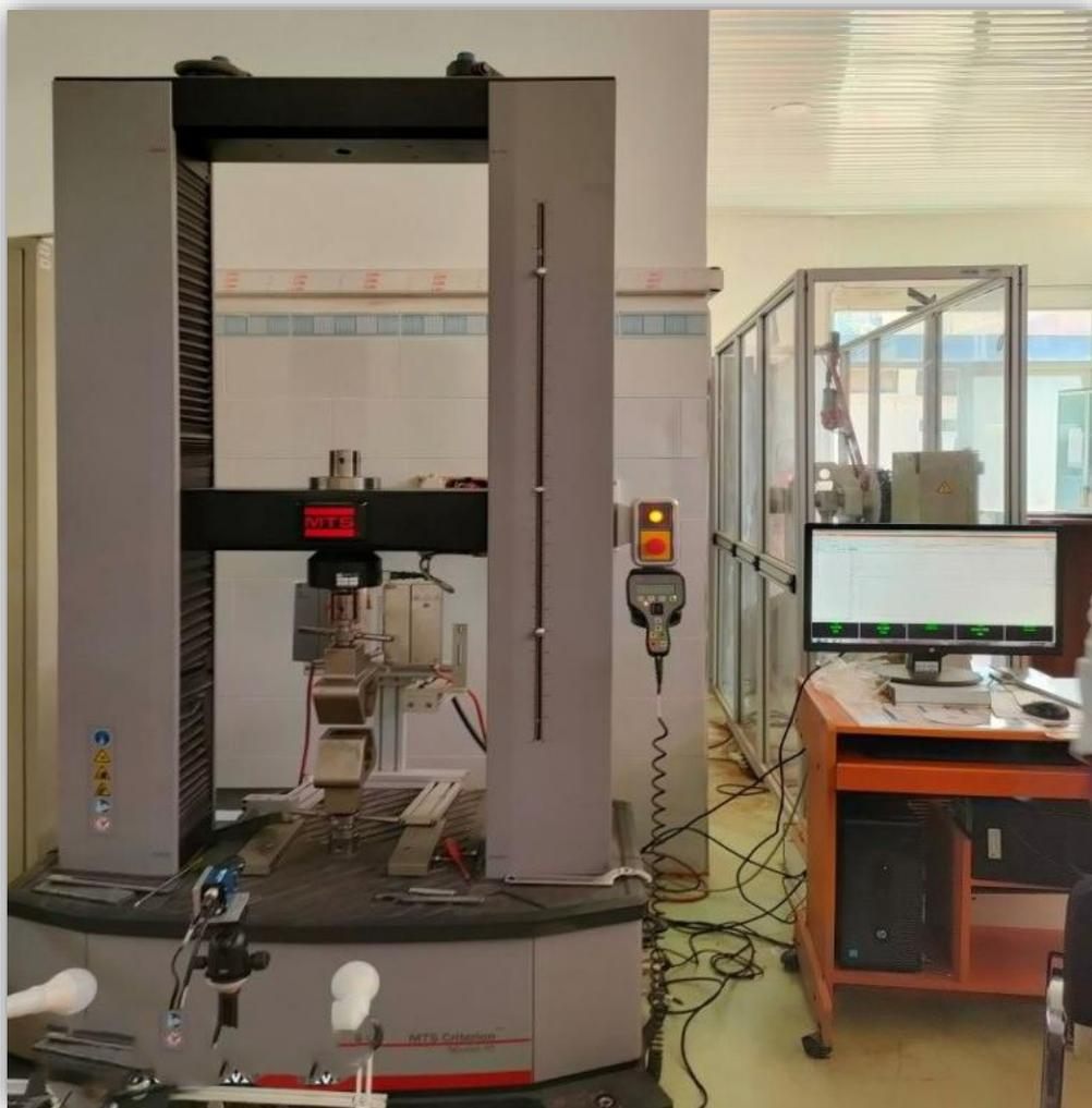
Figure 31 : Machine de traction (MTS Criterion™ Model 45).
