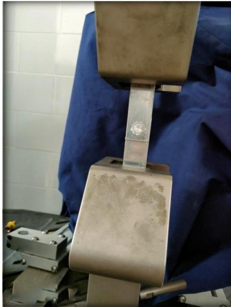
Figure 34 : Essai de traction d'une éprouvette soudée par FSSW
