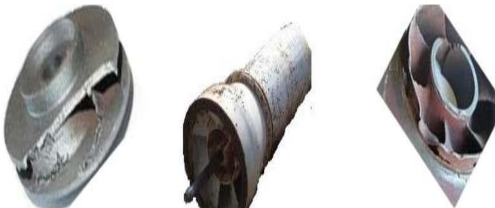
Figure 0-11: Dégâts de cavitation sur les éléments d'une pompe centrifuge [4].
