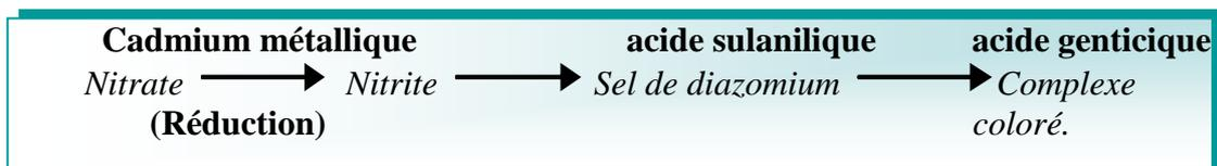
Ce dosage par spectrophotomètre est effectué à une longueur d'onde de 400nm pour les faibles concentrations et de 500nm pour les fortes concentrations.
