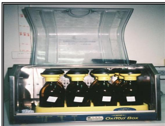
**Figure 10 : Respiromètre pour la mesure de la biodégradabilité des composés organiques.**
