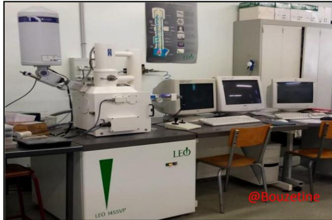
Fig.1.20. Photographie de l'appareil MEB équipé d'un détecteur EDS.
