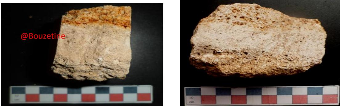
Fig.2.29.Echantillon après 50 cycles.
