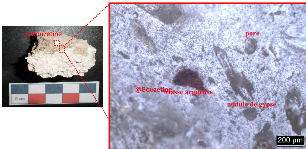
Fig.4.6. Vue sous loupe binoculaire du mortier Mfs.
