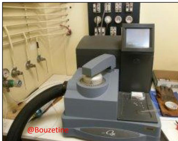
Fig.1.9. analyseur type ATG-DSC Q600,TA Instruments.
