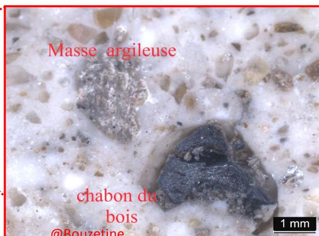
Fig.4.31. Vue sous loupe binoculaire du mortier Mm01.
