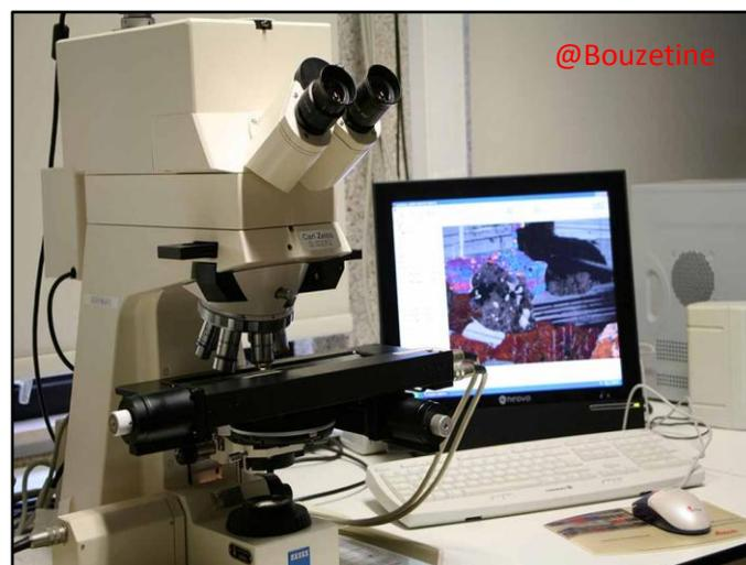
Fig.1.5. photo d'un microscope à lumière polarisante.
