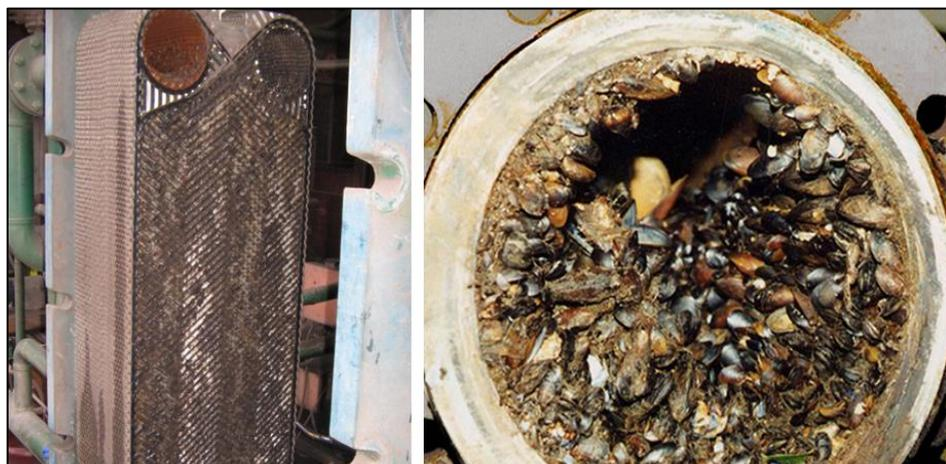
Figure III.4 : Encrassement biologique d'un échangeur de chaleur à plaques
