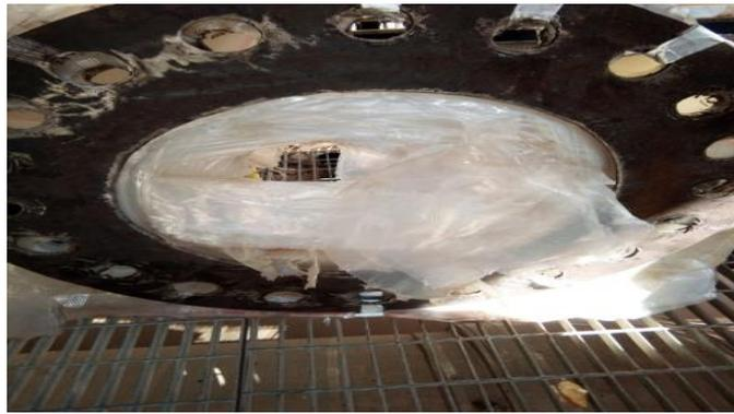
Figure V.9 : Etat du joint d'éclatement après le 6<sup>ème</sup> soufflage
