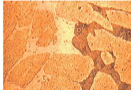
b. Corrosion sélective
