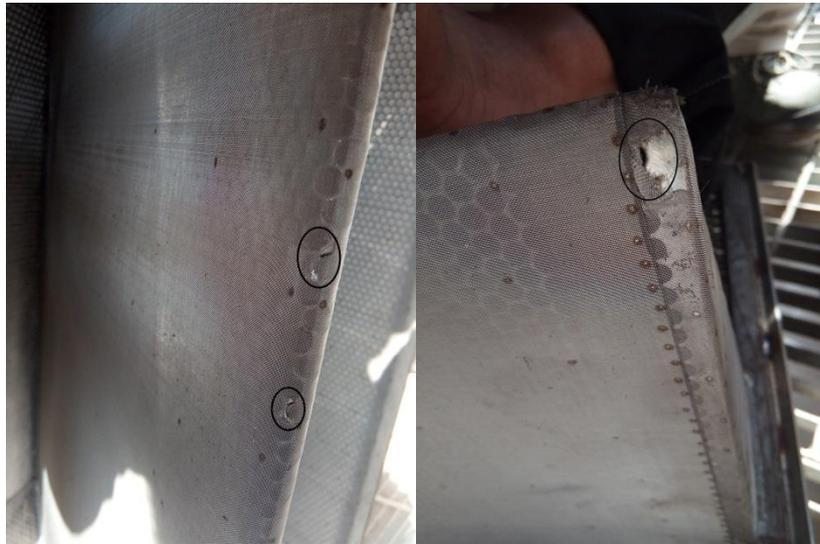
Figure V.12 Constat de déchirures au niveau du Fine Mesh
