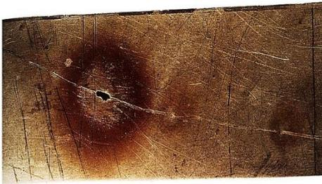
a. Corrosion fissurante
