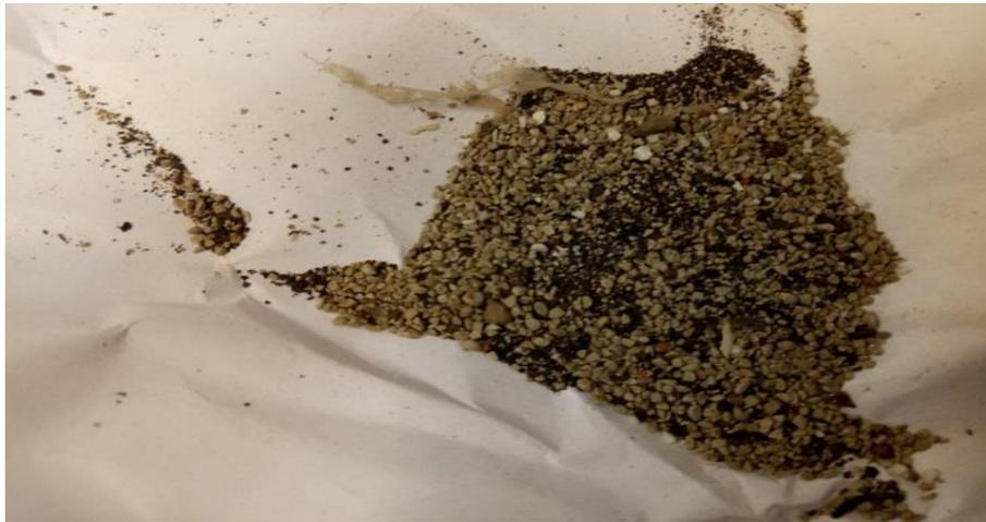
Figure V.5 : Débris récupérés après le 1<sup>ème</sup> soufflage de la boîte froide
