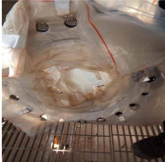
Figure V.7 : Etat du joint d'éclatement après le 3<sup>ème</sup> soufflage
