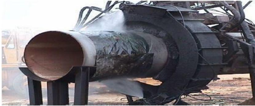
**Figure II.17 :** Revêtement d'un tube par le polyéthylène.
