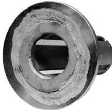
**Figure II.11** : Corrosion par crevasse sous un joint.
