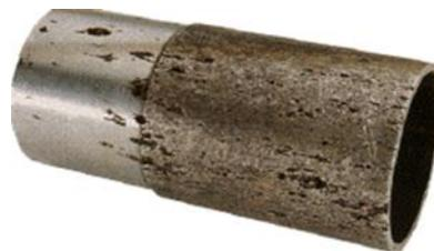
**Figure II.12** : Corrosion par piqûres d'un acier inoxydable
