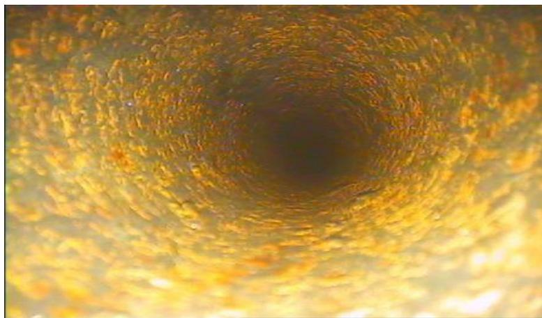
**Figure II.16 :** Corrosions interne en pipeline
