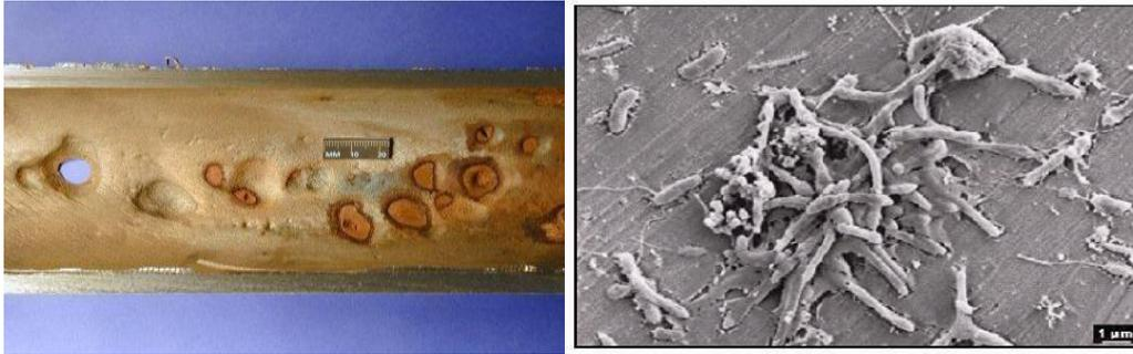
**Figure II.8 :** Colonie de bactéries sur un acier inoxydable.
