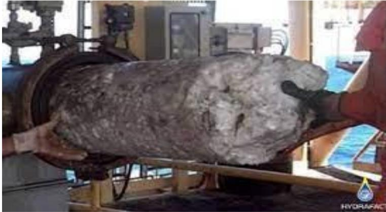
**Figure II.23:** un bouchon d'hydrates.
