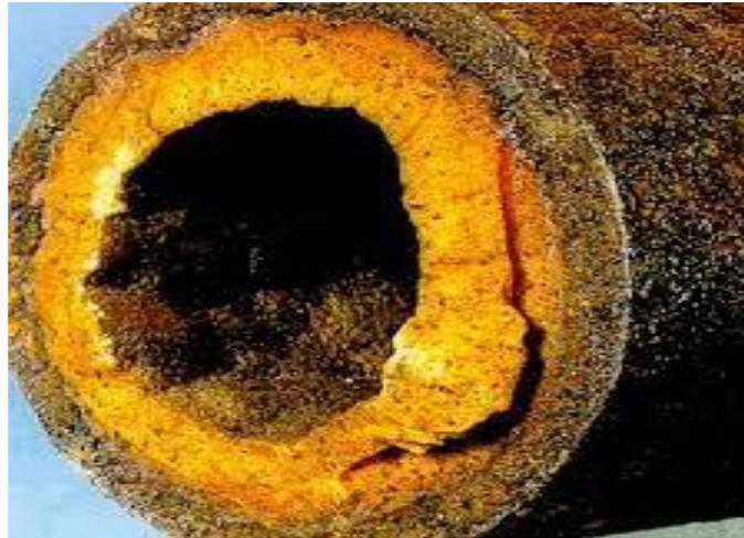
**Figure II.21** : Dépôt de paraffine dans un oléoduc.
