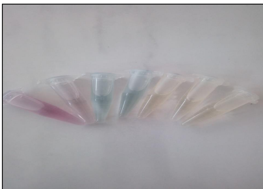
Figure III-5. Changement de couleur (violet → jaune) du DPPH selon le pouvoir antioxydant de l'HE testée (photo originale)
