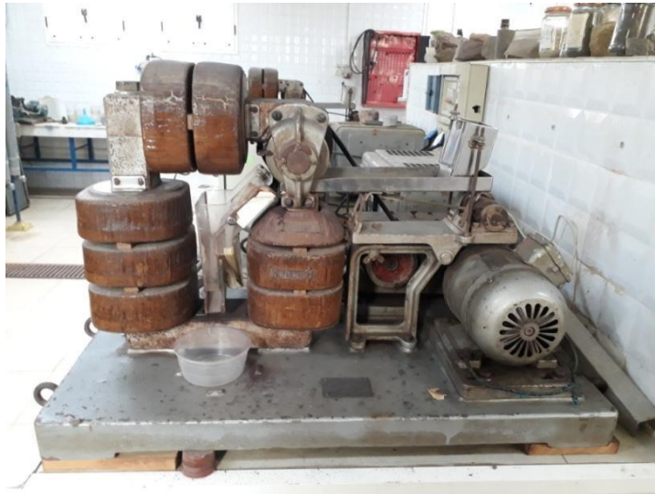
Figure III.7 : Séparateur magnétique à voie sèche utilisé.
