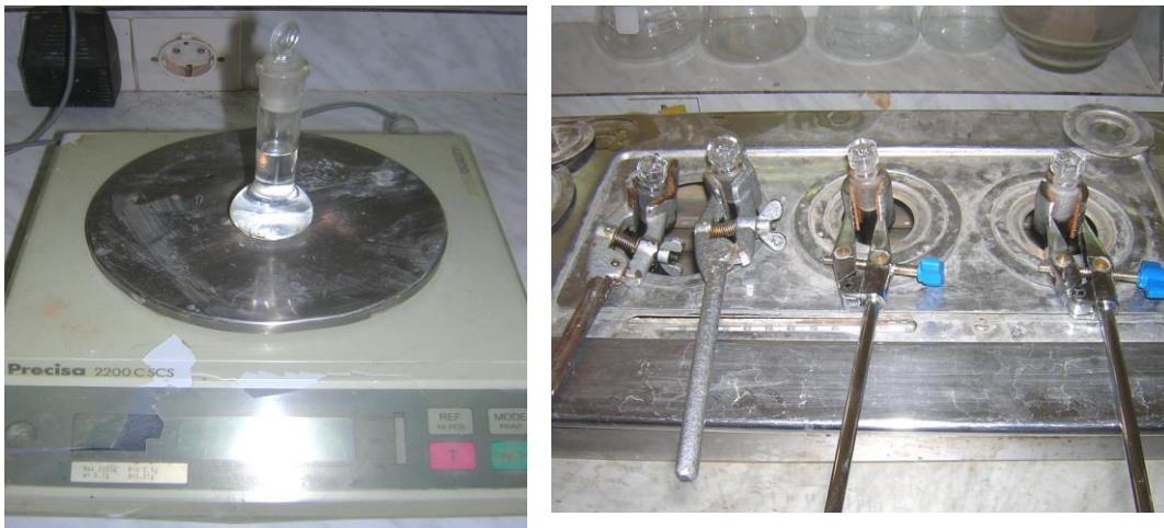
Fig. 25. La détermination de la masse volumique absolue. (M. Belaidi)
