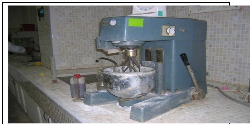
Fig.68. Malaxeur rotatif des mortiers. Laboratoire centrale de l'ENGOA.
