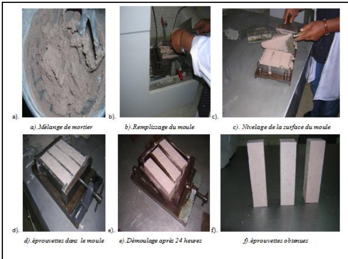
Fig.70. Opération de moulage des éprouvettes. (M. Belaidi).
