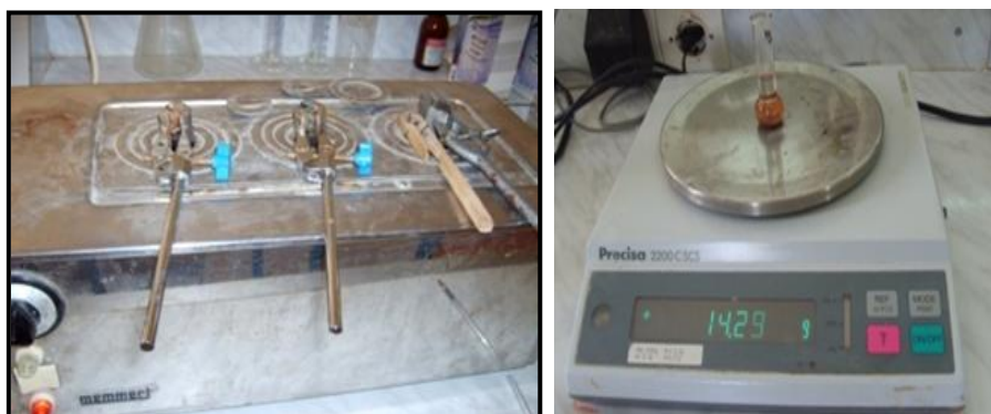
Fig.55. Les étapes de mesure de la masse volumique spécifique avec un pycnomètre. (M. Belaidi).
