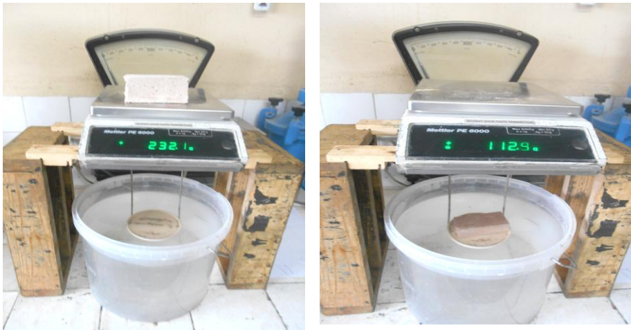
Fig. 26. La détermination de la masse volumique apparente. (M. Belaidi)
