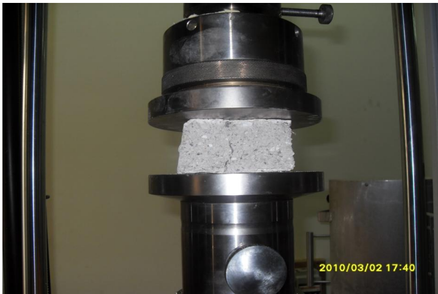
Fig.32.Essai de compression sur les éprouvettes 4x4x16 cm. (M. Belaidi).
