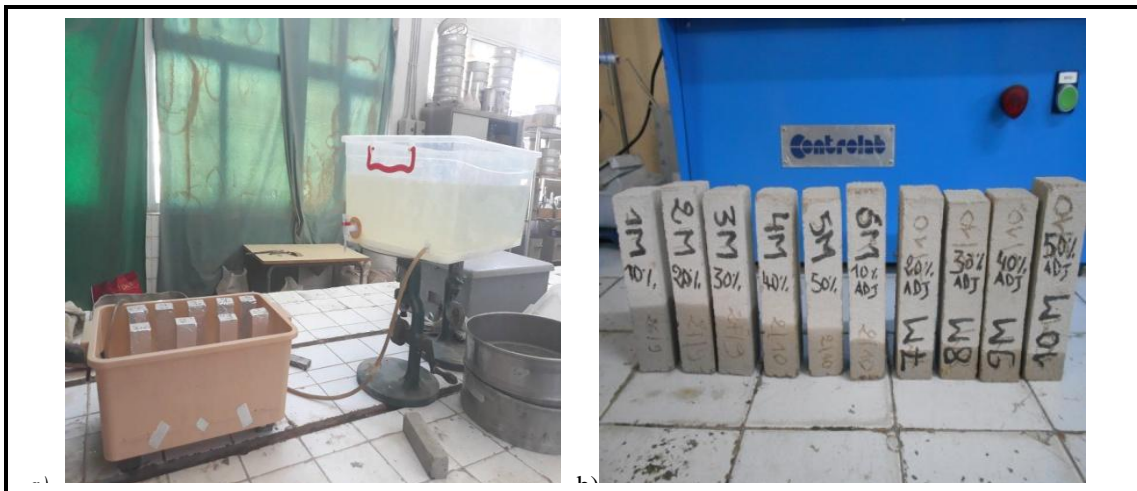
Fig.29. Essai de l'absorption par capillarité. Laboratoire centrale de l'ENGOA. (M. Belaidi).
