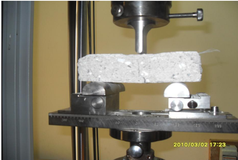
Fig.31.Essai de flexion 3 points sur les éprouvettes 4x4x16 cm. (M. Belaidi).
