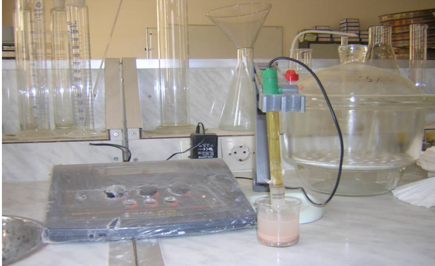
Fig.27. Calcul de pH à l'aide d'un pH mètre. (M. Belaidi)
