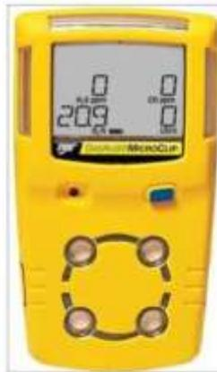
Figure III .14 : explosimètre
