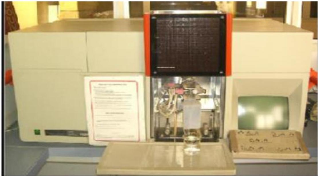
Photo(4) Le spectrophotomètre d'absorption atomique.
