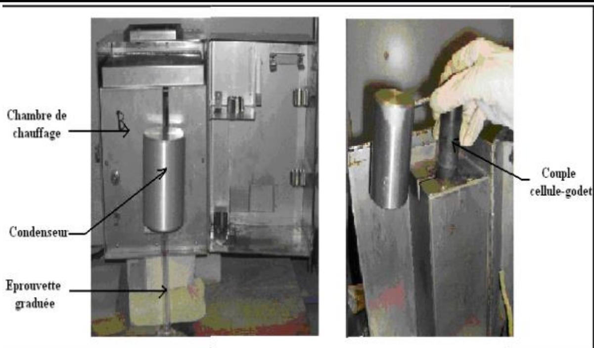
Photo (5) Montage de la cellule avec le godet.
