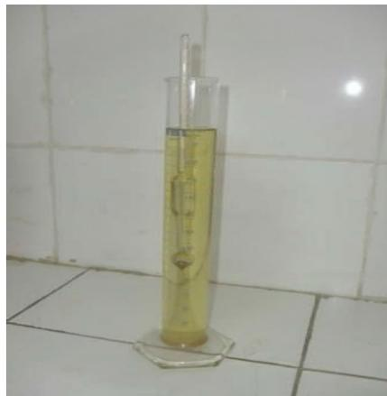
**Figure IV.5** : Appareillage de mesure de la densité
