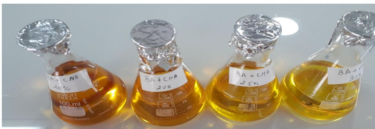
**Figure IV.13:** L'huile après traitement avec la variation de la concentration la bentonite et du charbon actif : (BA10%+CHA 10%); (BA20%+CHA 20%) ; ( A25%+CHA 25%) ; (BA30%+CHA 30%)
