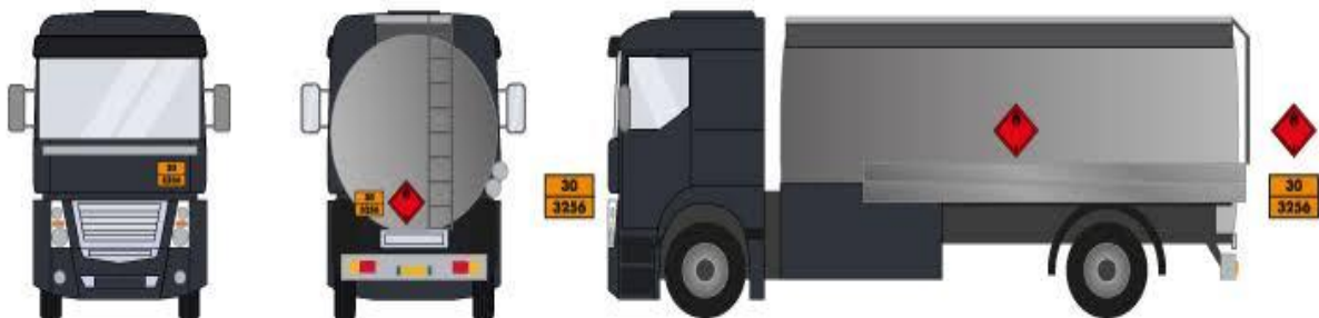
Figure II.4 : Les camions mono cuve[10]
