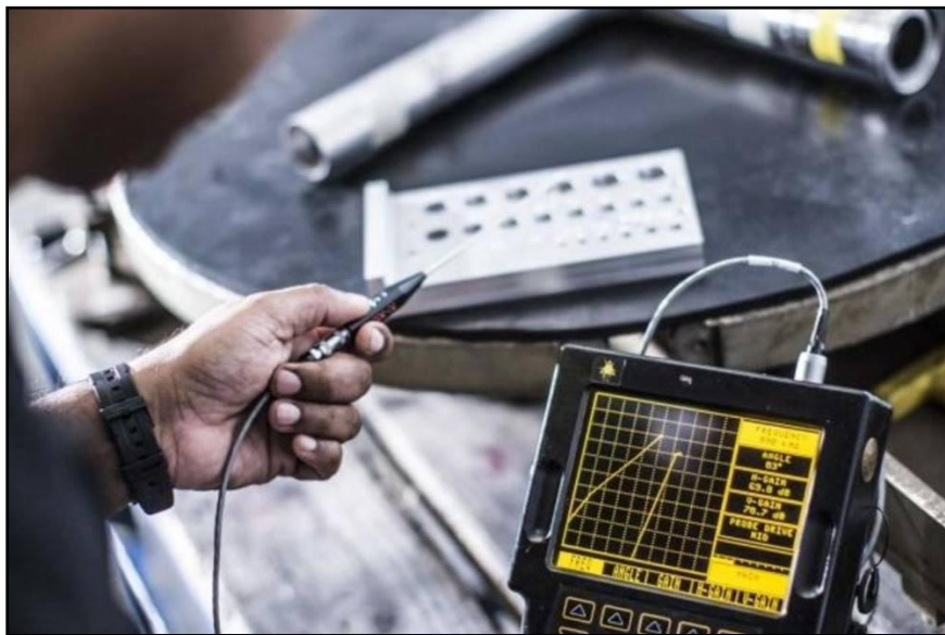
Figure I.9. Contrôle par courant de Foucault.
