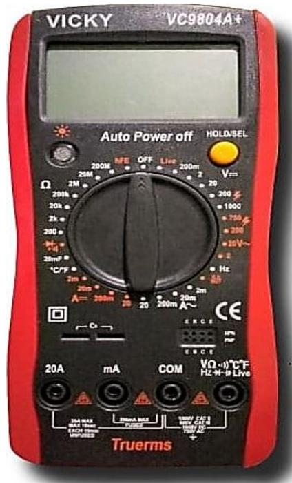
Figure III.3. Multimètre de marque VICKY .
