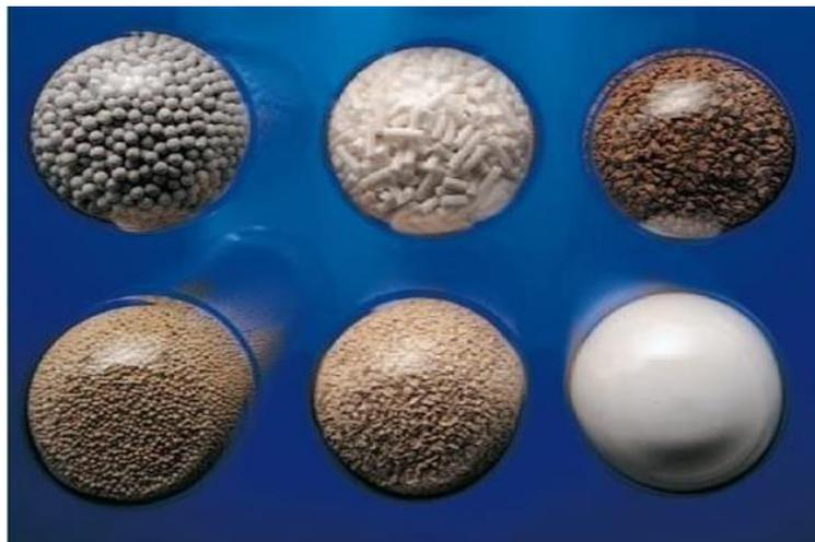
*Figure 2-3: Tamis moléculaire sous ses différentes formes*
