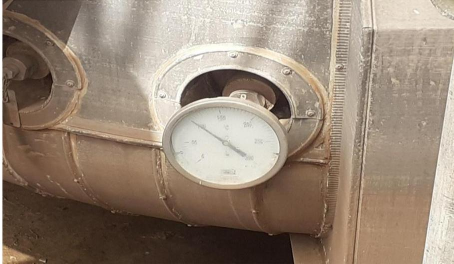
**Figure II.6 : Indicateur de température**
