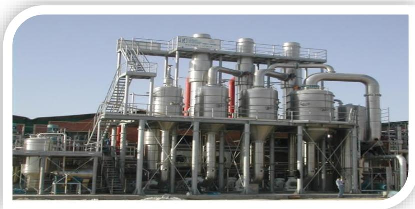
**Figure 08:** concentration de la purée de tomate (industriel) (Thermecatex, 2018)
