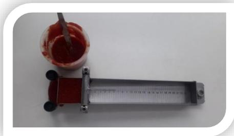
**Figure 20:** viscosimètre de Bostwick
