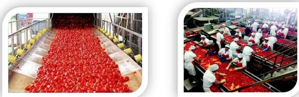
**Figure 06** : lavage et triage manuel de la tomate. (Le Temps, 2014 ; El aouni, 2015).
