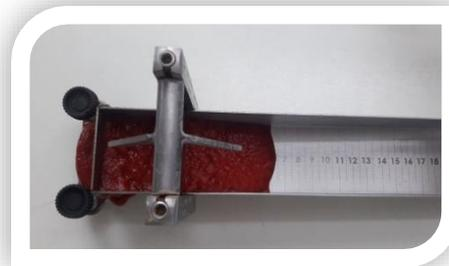
**Figure 21:** viscosimètre de Bostwick
