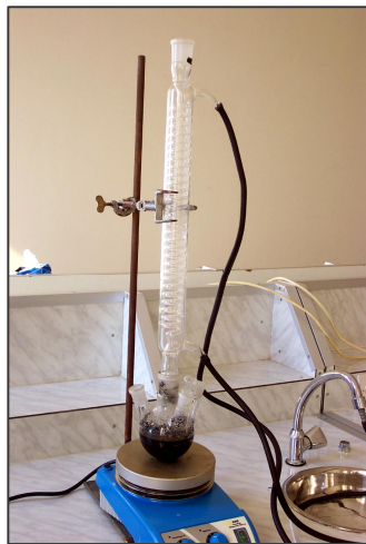
Figure VIII – 1 : Dispositif d'activation chimique de l'adsorbant
