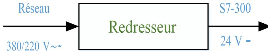
**Figure II. 4 :** Disposition des modules de l'API S7-300.
