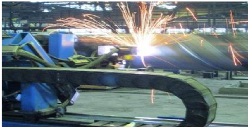
Figure III.4 – Opération de découpage des tubes.
