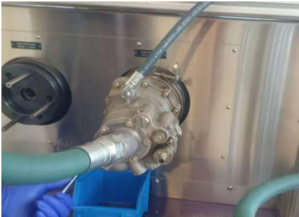
**Figure N°22: installation de la pompe sur le banc d'essai**
