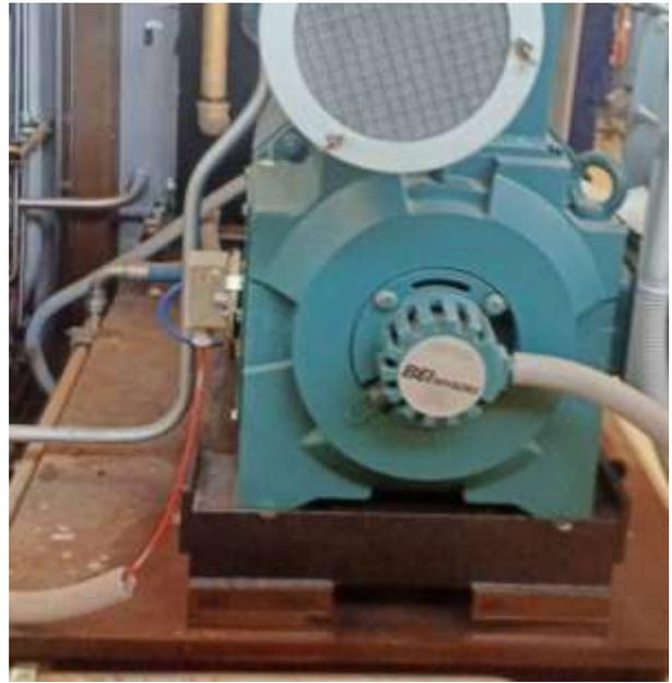
**Figure N°18: Génératrice tachymétrique**
