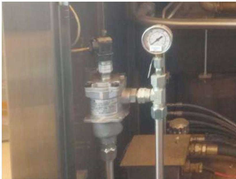
**Figure N°19: Electrovanne du banc d'essai**
