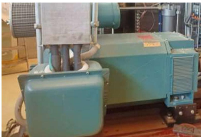
**Figure N°16: Moteur d'entraînement à courant continu**
