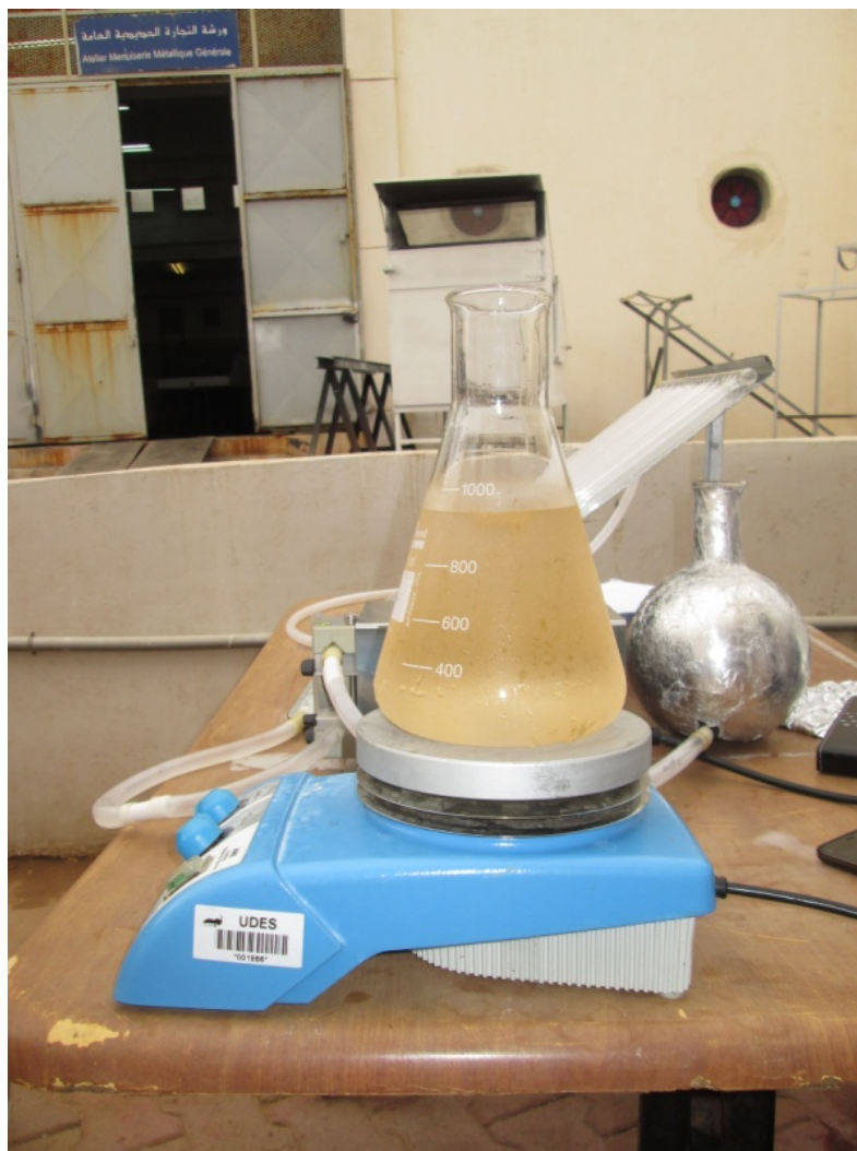
Figure III.3 — L'échantillon lors du traitement par photocatalyse.
