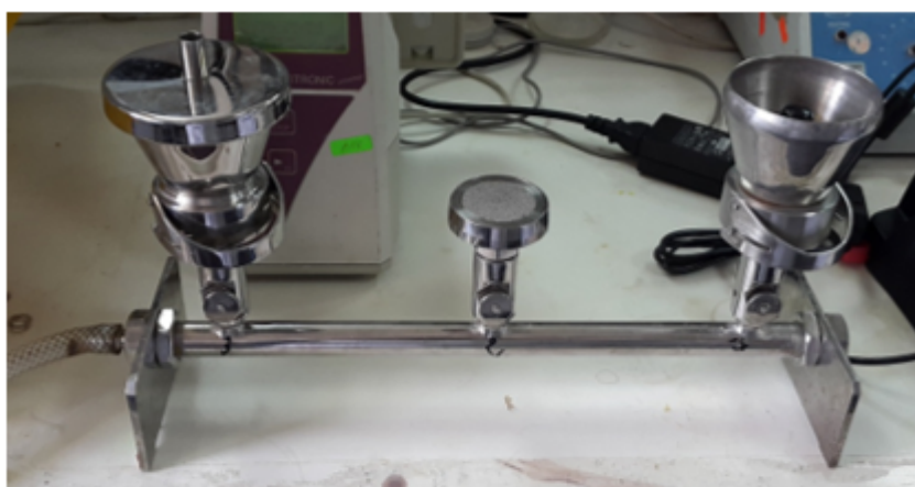
Figure A.22: pompe de filtration sous vide
