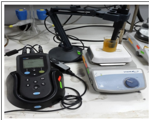
Figure IV.2 — multimètre HACH HQ 40d
