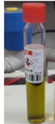
Figure A.11: cuve LCK514 (réactif+échantillon)
