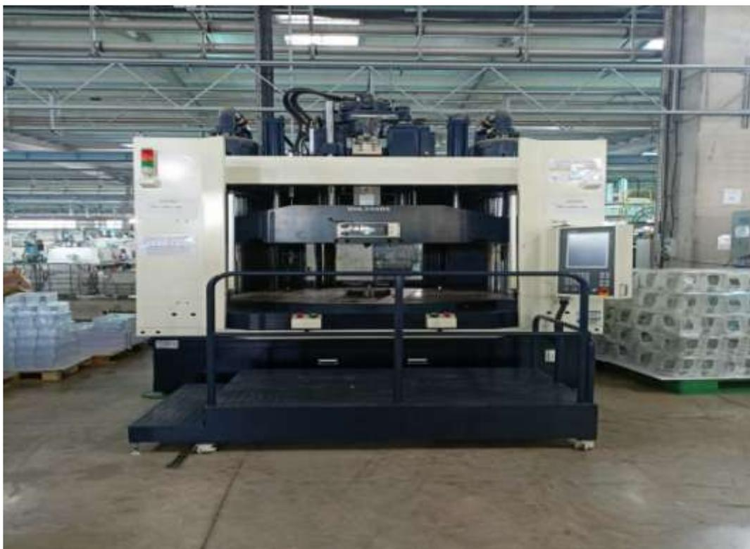
Figure 20 :Machine injection plastique vertical
