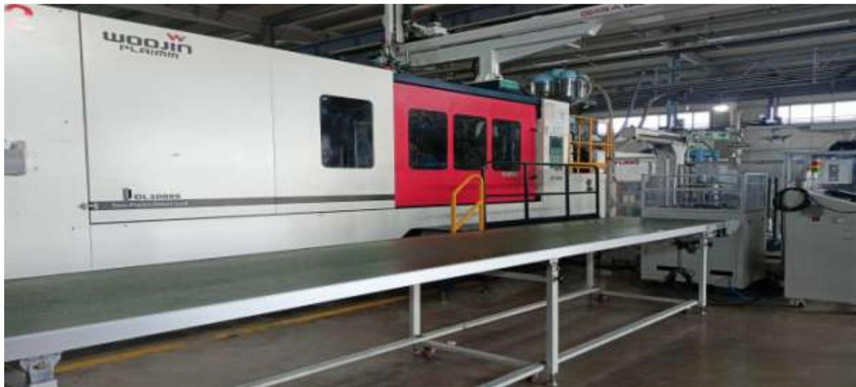
Figure 19 : Machine injection plastique DL2000S (Tow Platen Direct Lock)
