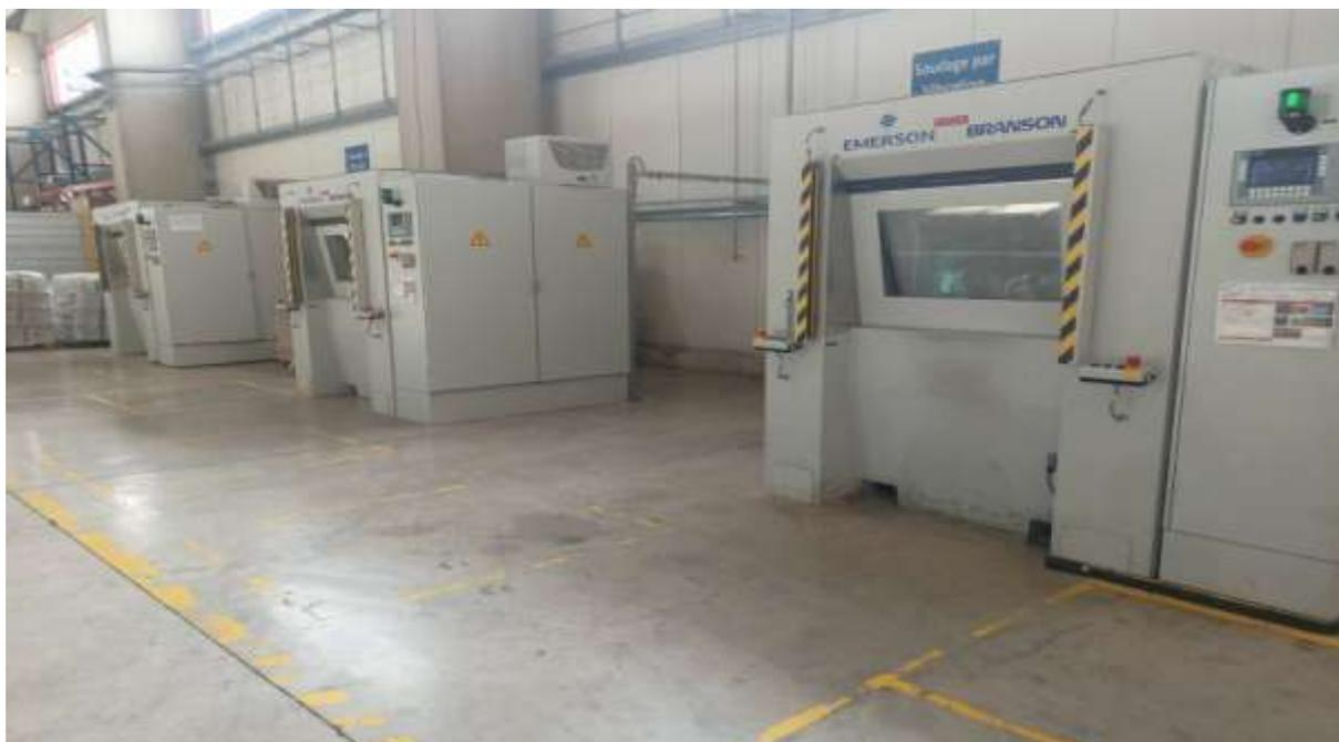
Figure 21 :Machine soudage plastique par vibration BRANSON
