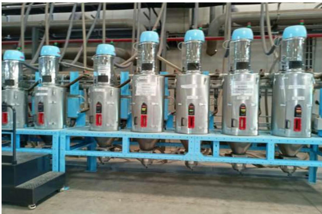
Figure 26 : les sécheur de la matière premier
