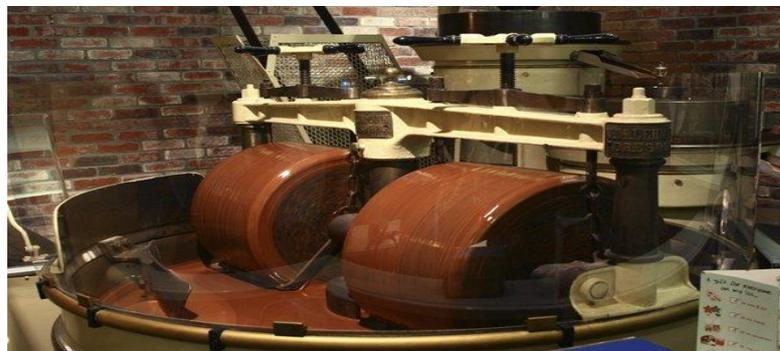
Figure I. 9 : Machine de conchage
