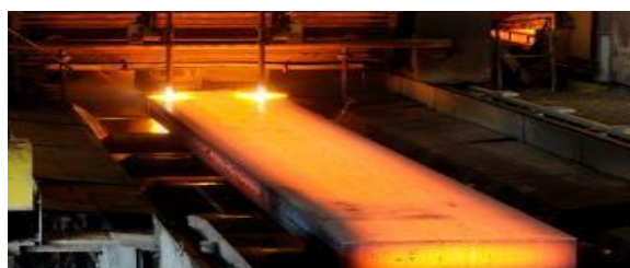
Figure 2.49 : Pièce d'acier en cours de laminage.
