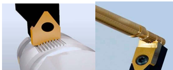
Figure 2.38 : Représentation du brochage extérieur.
