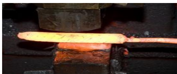
Figure 2. 47 : Réalisation d'un brut en forge libre.
