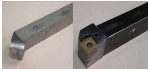
Figure 2.14: Outils de coupe, (a) en acier rapide (ARS), (b) a plaquette en carbure métallique.
