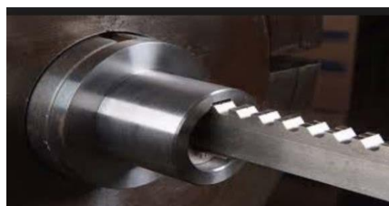
Figure 2. 36 : Représentation du brochage intérieure
