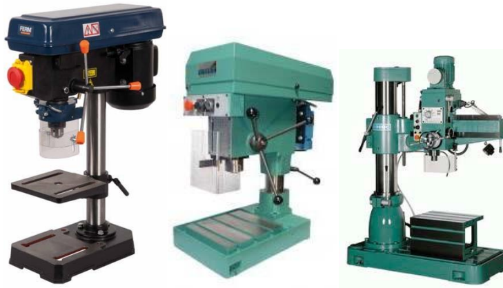
Figure 2.30 : Types de perceuses, (a) à colonne, (b) sensible d'établi, (c) radiale.
