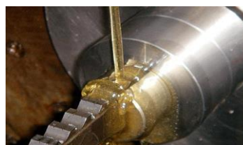
Figure 2.40 : Lubrification en Brochage.
