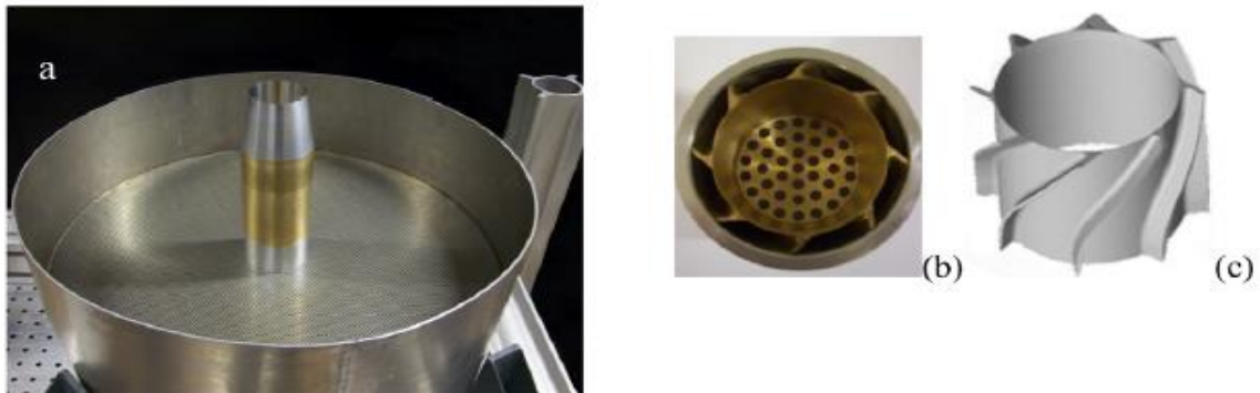
Fig. I.6 Brûleur développé par Nogenmyr K.J. et al (2009). [13]
