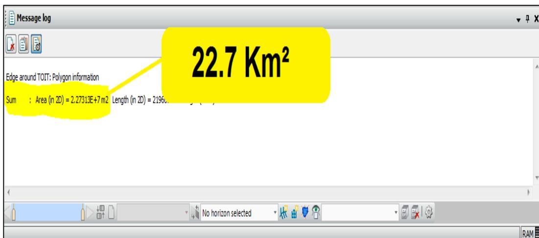
Figure IV. 4 : Résultat du calcul de la surface du réservoir INAO-1.
