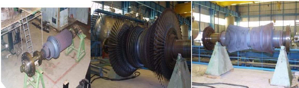
Figure I. 2 Images des trois corps de la turbine à vapeur.
