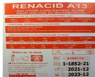
**Figure37: Composition de la solution concentrée acide**
