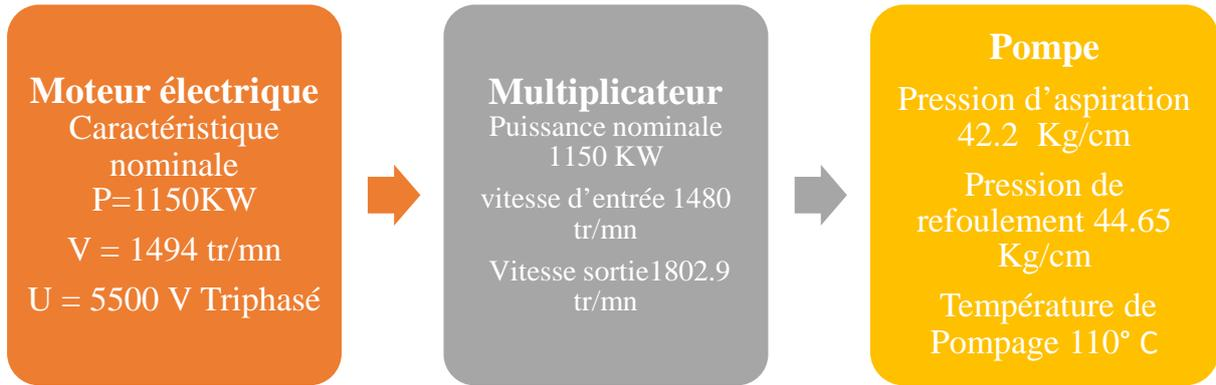
Figure II.8: Schéma du bloc de la motopompe
