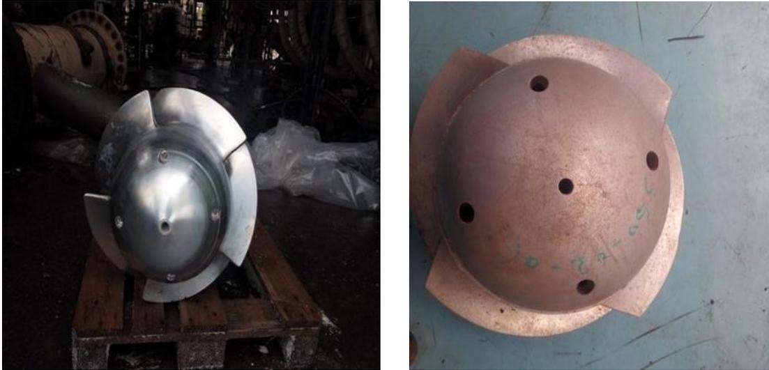
Figure II.10 : Différence entre les deux impulseur 4 ou 5 blade
