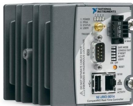
Figure II.12: Contrôleur temps-réel du cRIO.
