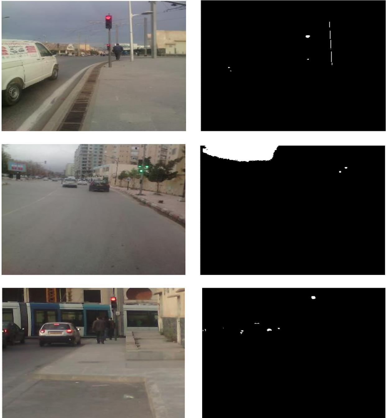
**Figure IV.7 :** Résultats d'application de seuillage.
