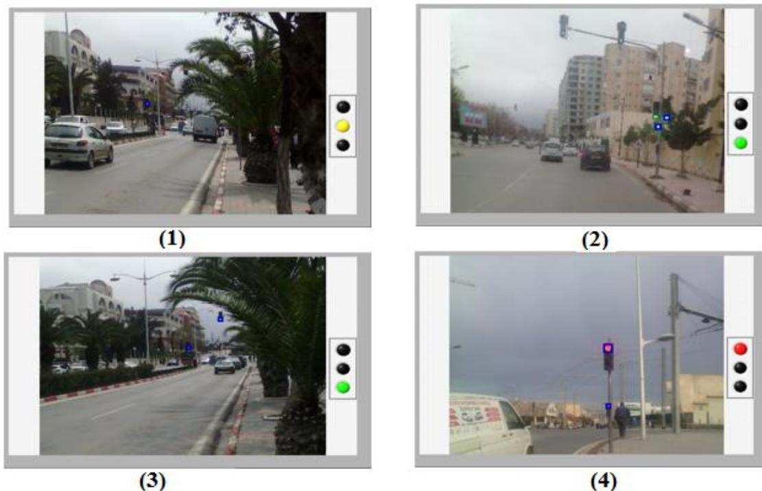
**Figure IV.8 :** Résultats de détection des feux tricolores.
