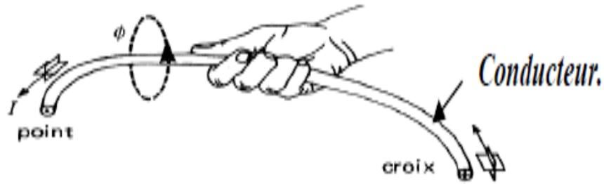
**Figure I-1:** Un champ magnétique dans un conducteur.
